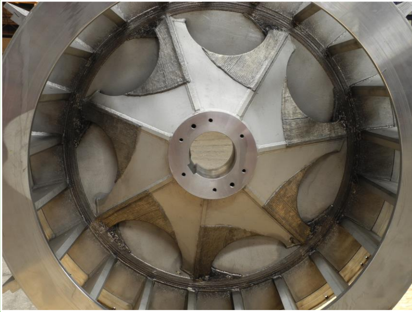
Verschleißgeschützter Rotor / Wear protected rotor
